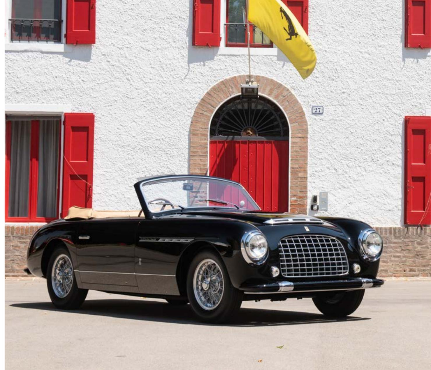
Der älteste ausgestellte Ferrari ist ein Ferrari 166 Inter von 1950. Die "166" in der Modellbezeichnung bezieht sich auf den Hubraum eines einzelnen Zylinders in Kubikzentimetern, wobei sich alle 12 Zylinder zu 1.992 ccm summieren. Der von Gioacchino Colombo entworfene Motor verfügte über ein Doppelverteiler- und Spulenzündsystem und einen einzelnen Doppelchoke-Vergaser, der 110 PS bei 6.000 U/min leistete.
