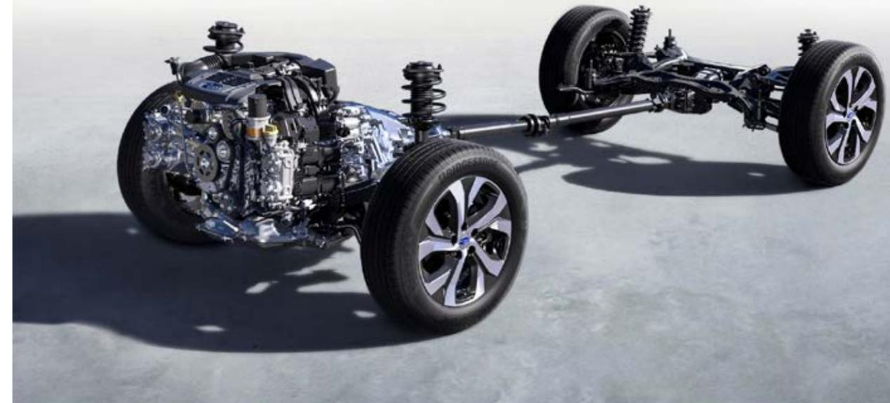
Die Folge sind ein niedriger Schwerpunkt und eine ausgewogene Gewichtsverteilung, was die ohnehin schon ausgezeichnete Stabilität und Traktion weiter verbessert – in nahezu jeder Fahrsituation und bei allen Straßen- und Witterungsbedingungen. In Verbindung mit der aktiven Drehmomentverteilung und dem modellabhängigen Allradmanagement-System X-Mode werden Fahrten auf und abseits befestigter Straßen selbst bei Schnee, Eis und Matsch problemlos gemeistert.
