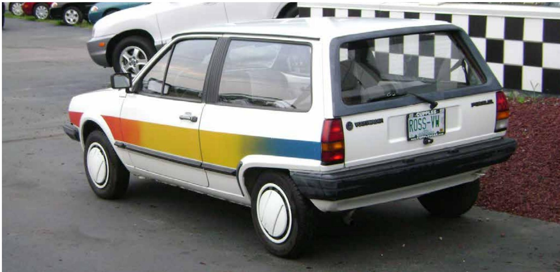
Der Prototyp war so konzipiert, dass er mit nur drei Litern Kraftstoff 100 km weit fahren konnte, was ihn für die damalige Zeit zu einem sehr sparsamen Auto machte. Er hatte einen Zweizylinder-Dieselmotor mit Direkteinspritzung und einen G40-Kompressor. Die beiden Zylinder verdrängten nur 858 Kubikzentimeter und ein hitzebeständiger Schaumstoff kapselte den Motorraum ein, um die Motorgeräusche und Vibrationen zu minimieren.
