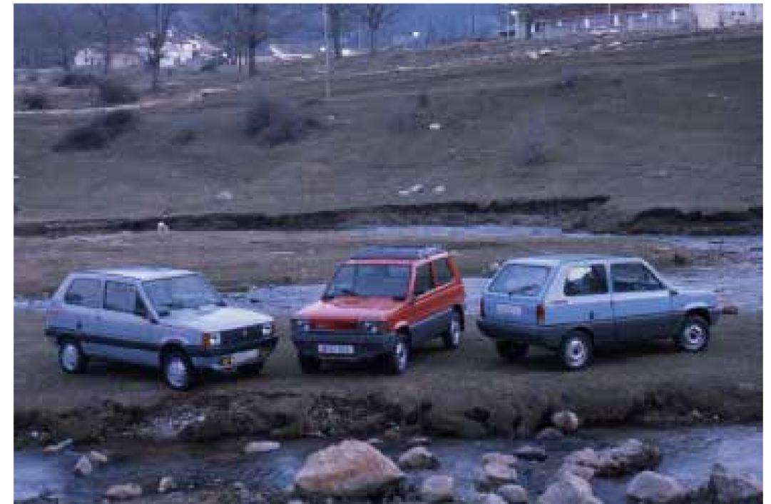
des sogenannten kleinen Mannes. Wahlweise 25 kW (34 PS) oder 33 kW (45 PS) Leistung sowie eine für Gegenden mit schlechter Benzinqualität auf 29 kW (40 PS) reduzierte Variante reichten aus, um bis zu fünf Personen und bei Bedarf auch einiges an Ladung an ihr Ziel zu bringen. Für holprige Pfade war der SEAT Panda Montaña mit höhergelegtem Fahrwerk, Unterfahrschutz und Gittern vor den Scheinwerfern die optimale Wahl.
