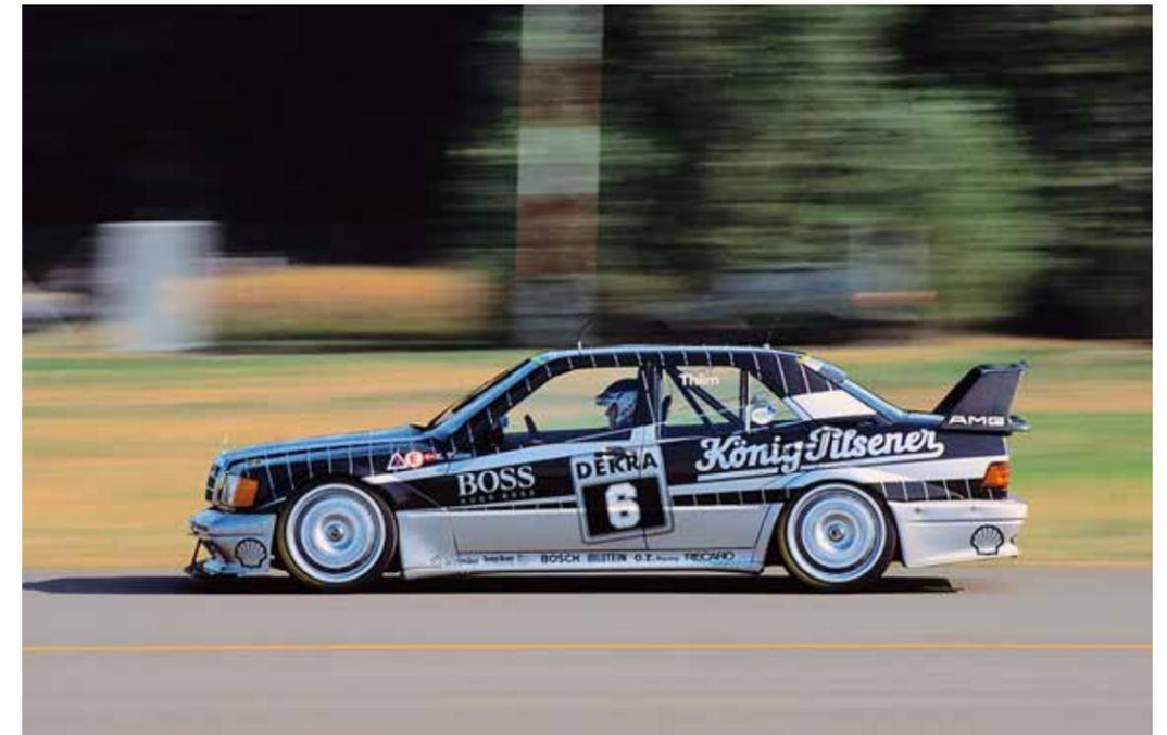
optimieren, hat der Spoiler einen herausziehbaren Flap an der oberen Querleiste. Die untere Spoilerleiste im Heck lässt sich kippen, und der Frontspoiler ist in zwei Stufen in Längsrichtung verstellbar.
