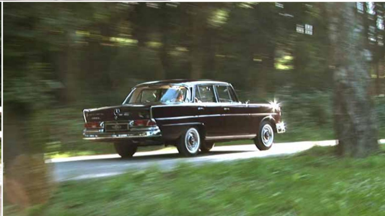
**A**uffälliges Merkmal des 220 Sb ist die sogenannte doppelte Stoßstange, das verchromte Lufteinlassgitter (vor der Windschutzscheibe) und die verchromten Radzierblenden. Am Heck die größeren Rückleuchten und die Zierleisten an der Oberkante der Heckflossen.
