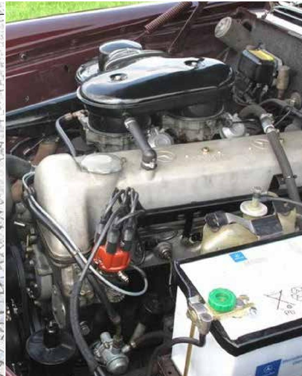
**D**er Sechs-Zylinder-Reihenmotor des hier gezeigten Klassikers MB 220 Sb verfügt über einen Hubraum von 2195 ccm und bringt eine Leistung von 105 PS bei 5000 Umdrehungen pro Minute. Die Höchstgeschwindigkeit liegt bei 165 KM/Stunde. Um eine effektive Schwingungsdämpfung zu erreichen sind an Vorder- und Hinterrädern der W 111-Modelle die Stoßdämpfer ganz außen untergebracht. Scheibenbremsen an den Vorderrädern und eine Zweikreisbremsanlage sorgen für einen sicheren Stillstand. ▶
