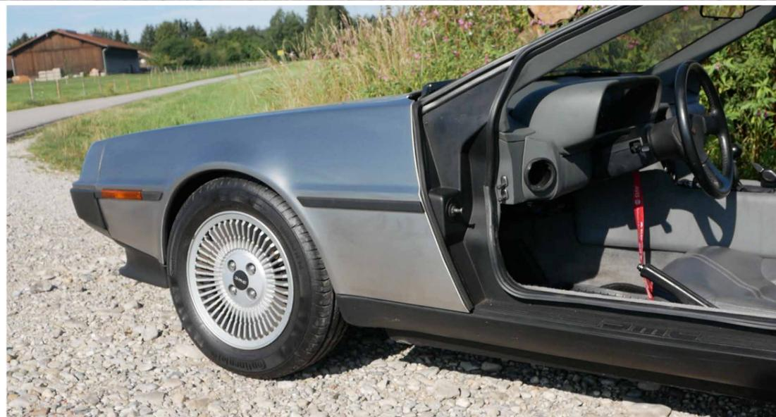
**A**ls Partner holt sich DeLorean Lotus mit an Bord. Der zweisitzige Flügeltürer entstand auf dem Chassis des Lotus Esprit. Die Entwicklung des DMC-12 dauerte zwei Jahre. Eine sehr kurze Zeit für ein solches Projekt und dies führte zu einigen Problemen in der Serienproduktion. Die Karosserie ist komplett aus gebürstetem Edelstahl gefertigt. Zier- und Anbauteile aus Kunststoff. Im irischen Belfast wurde mit stattlichen Zuschüssen eine große Fabrik für die Produktion des DeLorean gebaut. ▶
