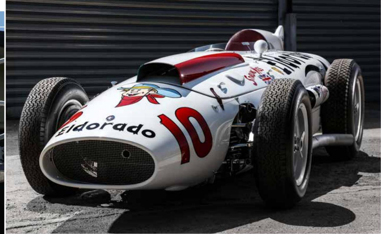
Um das Gewicht zu reduzieren, wurden Halibrand-Magnesiumräder und 18-Zoll-Profilreifen von Firestone mit Heliumfüllung montiert. Die von Fantuzzi handgefertigte Aluminiumkarosserie zeichnete sich durch eine aerodynamische Leitflosse hinter dem Cockpit und eine Vergaserhülse auf der Motorhaube aus. Insgesamt wog das Fahrzeug 758 Kilogramm.
