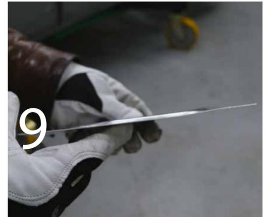
Sicherlich ist bei Ihnen beim Sickenformen auch schon folgendes Problem aufgetreten. Formt man längere durchgehende Sicken in ein Blech, dann tritt folgendes Phänomen auf. Die Sicken sind zwar perfekt geworden, aber das Blech hat nun eine erhöhte Spannung und ist stark verformt. Die Spannung führt zu einem hin und her "Springen" des Blechs, was auch deutlich zu hören ist.
