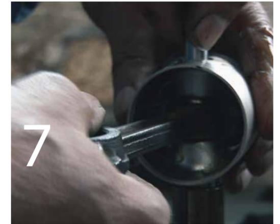
**B**eim Einbau eines Kolbenbolzens sind die Bolzenpassungen zu beachten. So gibt es Kolben mit einem Spiel von 0,005 bis 0 mm, bei denen sich ohne großen Kraftaufwand über einfachen Fingerdruck der Bolzen eindrücken lässt. Bei einem Spiel von 0,005 bis 0,0075 mm ist der Bolzen so locker, dass er locker in der Führung hin und her gleitet.
