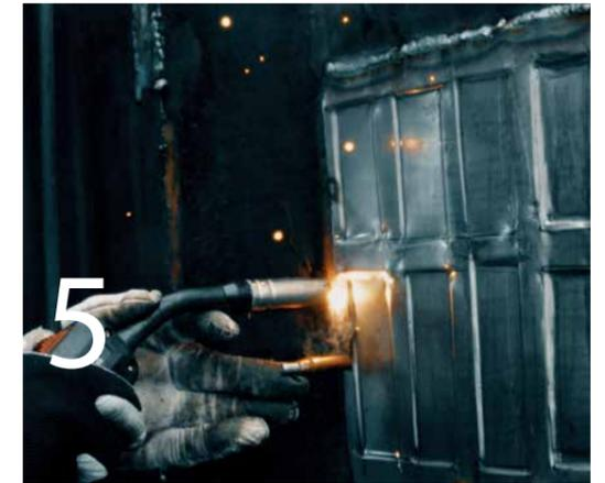
**D**as Bodenblech ist fertig umgeformt und kann nun eingeschweißt werden. In das bestehende Bodenblech wird nun ein entsprechender Ausschnitt geschnitten. Dieser Ausschnitt ist etwa 10 bis 20 Millimeter kleiner als das Ersatzblech. Die Ränder rund um das Ersatzblech müssen blank geschliffen sein.
