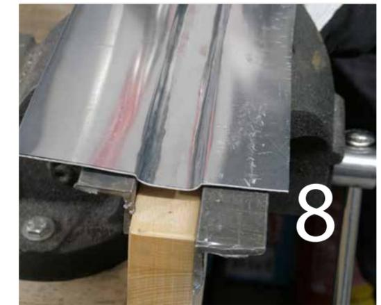
Sicken in Blech zu treiben ist ein der häufigsten Arbeiten an der Karosserie. Um diese Sicken gleichmäßig zu treiben, kann man zwei Winkeleisen, getrennt durch zwei Holzklötzen, die so breit sind wie die endgültige Sicke, in einen Schraubstock klemmen. Mit dem Schlicht und Streckhammer wird das Blech entlang der Winkeleisenschiene stückweise in die Tiefe getrieben. Sobald
