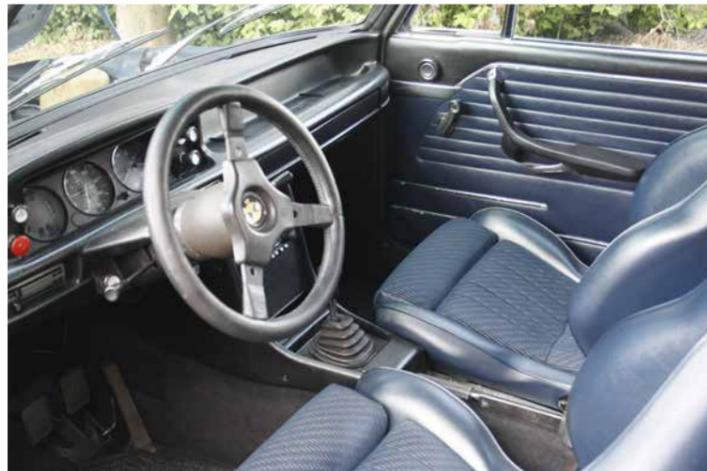
Im Fond ist allerdings die Bewegungsfreiheit etwas eingeschränkt. Die beiden seitlichen Fenster im Fond lassen sich für die Frischluftzufuhr über einen Mechanismus seitlich ausklappen. Der Blick über das Lenkrad gibt die drei rechteckig eingefassten Uhren frei. Das Armaturenbrett und die Ablage wurden aus Sicherheitsgründen weich gepolstert. Schalensitze vermitteln den sportlichen Komfort. ▶
