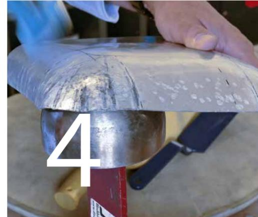
**A**brgerundete Ecken in flachen Blechen sind häufig an Dachkanten, Kotflüglecken oder an Motorhauben zu finden. Solche abgerundete Ecken lasen sich mit einfachen Mitteln formen.
