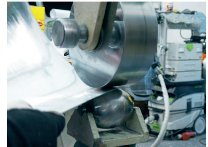
In dieser Folge der Grundlagen der Rollenstreckmaschine zeigen wir, wie an der Rollenstreckmaschine ein Konkaver Flansch geformt werden kann. Zur Vorbereitung des Blechs wird eine Blechtafel zum Abrunden durch die Rollenmaschine geführt. Damit wird das Blech vorab gewölbt.
