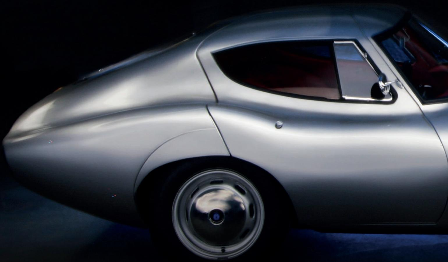
Der hier gezeigte Veritas RS, Baujahr 1953, ist ein ganz besonderes Exemplar. Die Karosserie dieses Einzelstück wurde in der Meisterschule Kaiserslautern angefertigt. Die Türen ziehen sich bis über die Dachlinie hinaus, um ein besseres Einsteigen zu ermöglichen. Wegen des Gitterrohr-Rahmens ist der Schweller sehr breit. Die Innenausstattung aus rotem Leder ist auffallend elegant.
