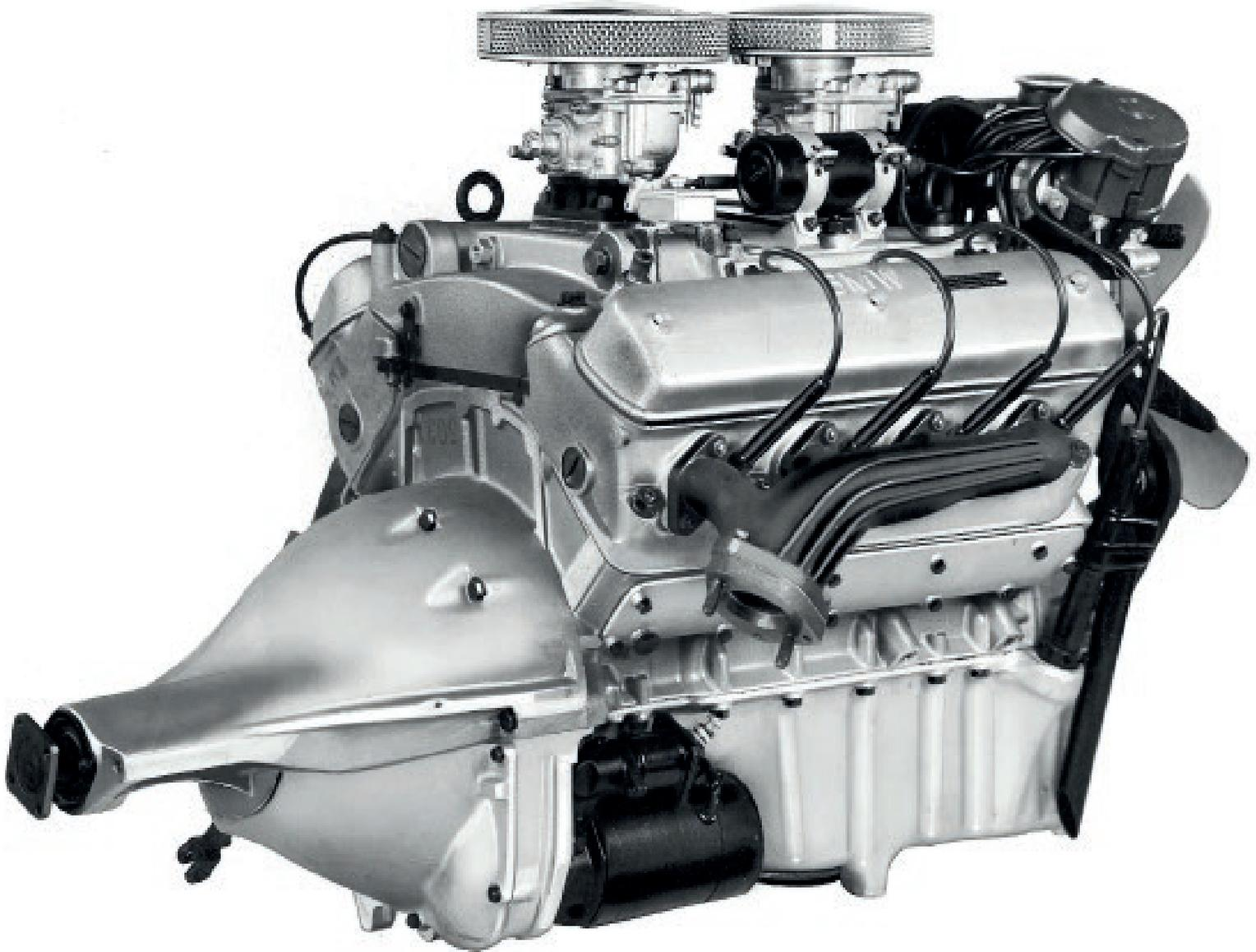
Der Frontmotor, der erste deutsche Nachkriegs V-8 Motor mit Leichtmetallblock, bringt 140 PS (103 KW) Leistung bei 4800 U/min unter die Motorhaube und transportiert das Fahrzeug auf eine Spitzengeschwindigkeit von rund 190 km/Stunde.
