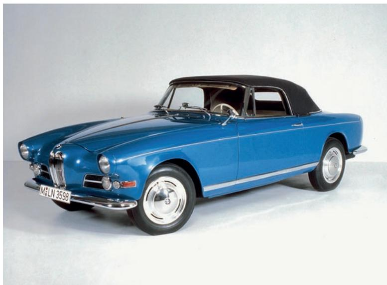
Die fein geschwungene sportliche Karosserie des 503 ruht auf einem Vollschutzrahmen. Die vorderen Halbachsen werden an jeweils zwei Dreieckquerlenkern geführt, die auf Nadeln gelagert sind, was eine besonders feinfühligere Federung zur Folge hat, die auf längs liegenden Torsionsstäben ruht.
