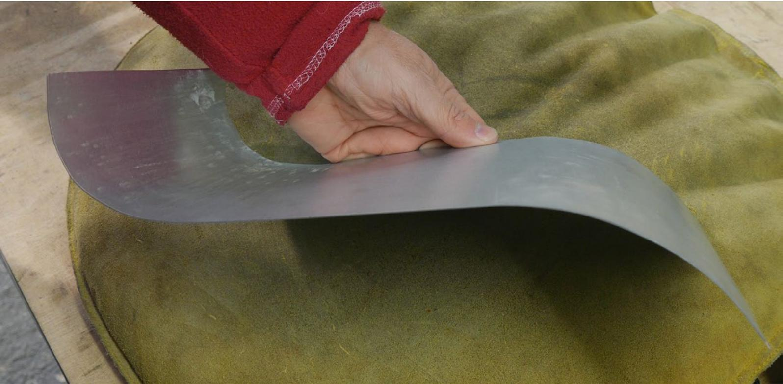
Treiblöffel aus Kunststoff oder Holz kommen immer dann zum Einsatz, wenn flaches Blech gewölbt werden soll. Das Blech wird flach auf den Sandsack aufgelegt und mit dem Treiblöffel mit gleichmäßigen flachen Schlägen getrieben. Verwendet man einen flachen Treiblöffel erreicht man eine sanfte Wölbung.
