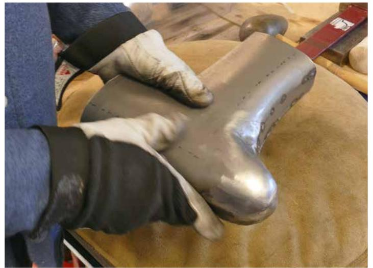
ge korrigiert. Stückweise wird nun die Naht komplett verschweißt. Die Schweißnaht kann mit einem Winkelschleifer komplett verschliffen werden. Die Form ist nun fertig und wird durchgehend verschweißt.
