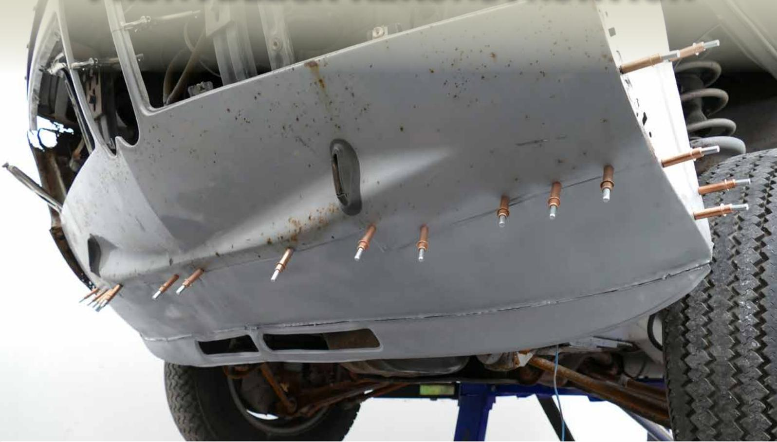
Die untere Kante des Frontblechs ist komplett weggerostet. Vermutlich hat sich zwischen zwei aufeinander zulaufenden Blechen Wasser gesammelt und das Blech zum Rosten gebracht. Um nun diesen Teil der Frontmaske aufzubauen wird zuerst eine Papierschablone angefertigt. Anhand der Papier Schablone kann auch bereits erkannt werden, an welcher Stelle das Blech konvex geformt werden muss.
