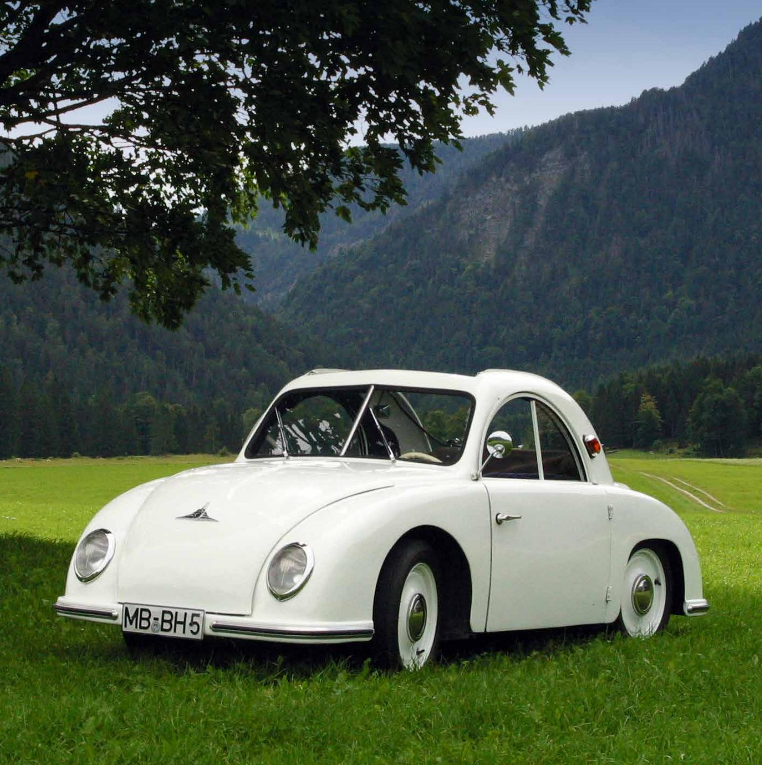
Der zwischen 1950 und 1955 5100 mal gebaute Champion 400 basiert auf einem Zentralrohrrahmen mit 1,80 m Radstand. Die gelungene Karosserie wurde bei Drautz mit nur wenigen Preßwerkzeugen kostengünstig gefertigt und bietet mit 1,50 m schon fast die Breite der damaligen Mittelklasse-Wagen.
