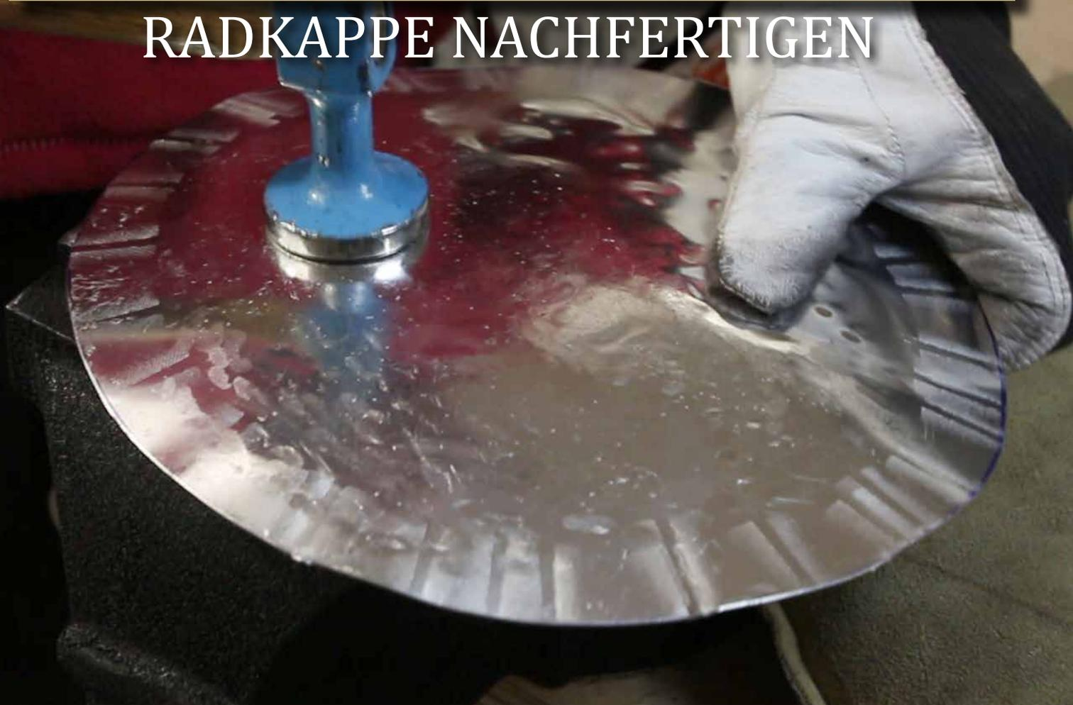
Gewölbte Formen, wie zum Beispiel eine Radkappe können durch das Runden mit einem Hammer und einem entsprechenden Fäustling erreicht werden.
