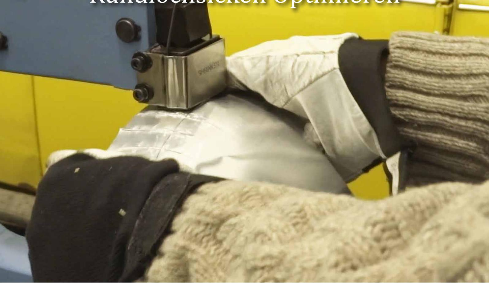
Worin liegt der Unterschied zwischen einem flachen und einem tiefen Streck- und Stauchgerät. Wir vergleichen die Funktionalität beider Streck- und Stauchgeräte anhand einer einfachen Übung. An einem Blech werden zwei gewölbte Ränder geformt. Die Umformtiefe ist festgelegt.
