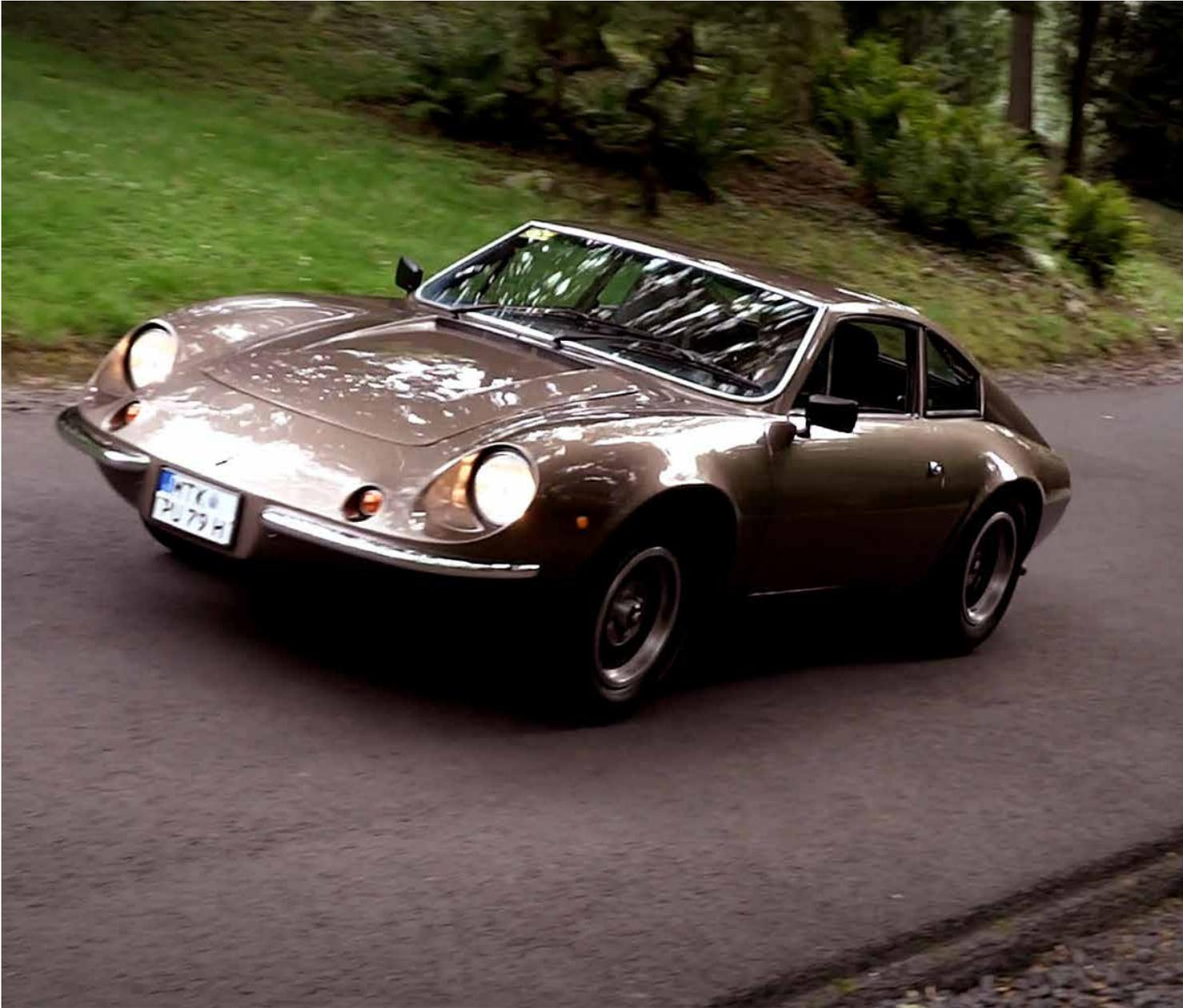
Das Puma GTE Coupé bietet dem Fahrer einiges an Fahrspaß. Im Heck wirkt der 1,6 Liter Vierzylinder-Boxermotor mit einer Leistung von 55 PS bei 4200 U/min. Laut Werksangabe erreicht der Wagen mit den 9,7 kg/PS Leistungsgewicht eine Höchstgeschwindigkeit von 170 km/h. Ein vollsynchronisiertes Viergang-Getriebe überträgt die Kraft auf die Hinterachse.
