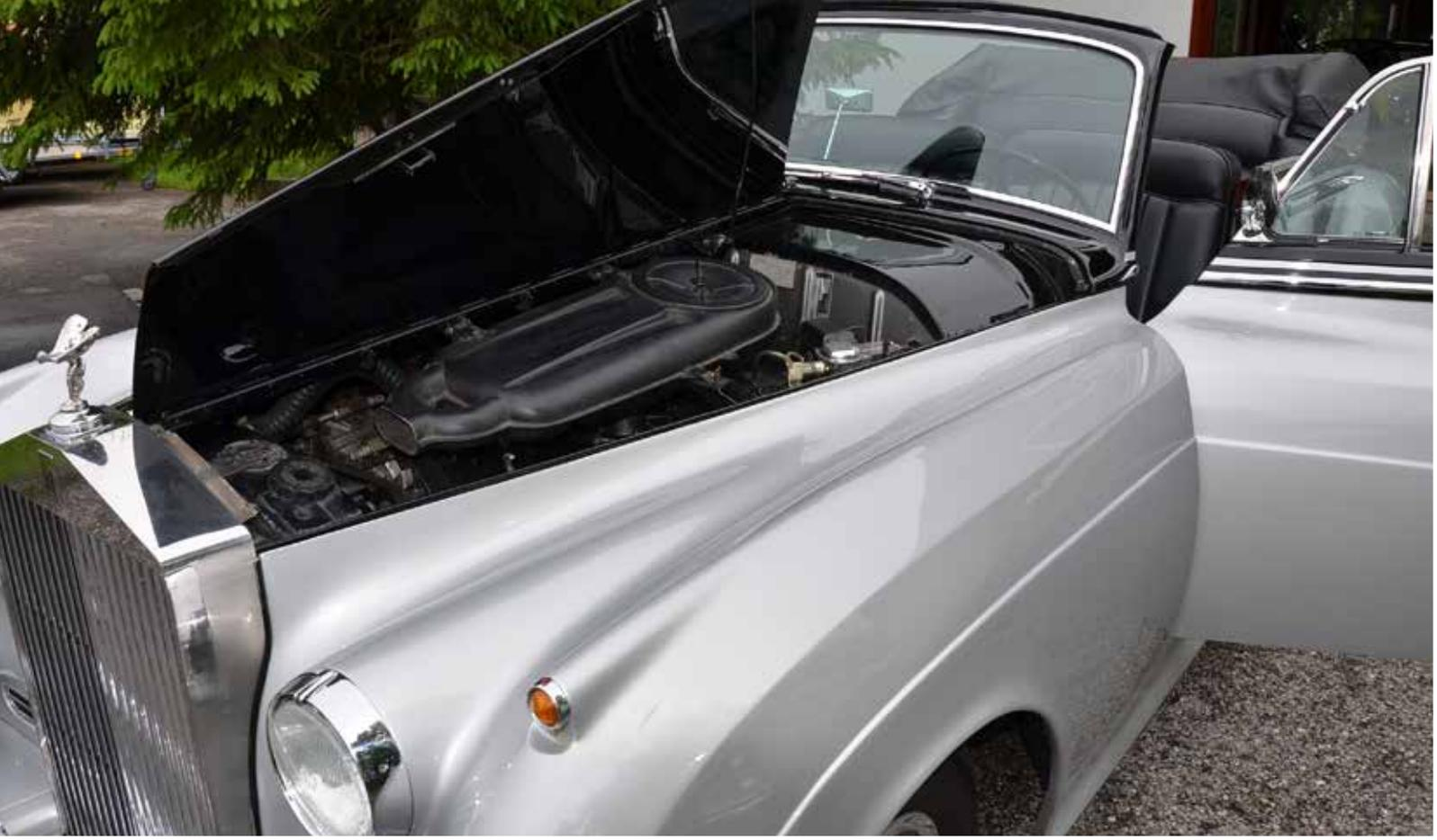
Ausgestattet sind die Silver Clous MK2 Modelle mit einem 6,2 Liter V8 Motor. Der laufruhige aber kraftvolle Motor bringt das 2,1 Tonnen schwere Gefährt auf eine Höchstgeschwindigkeit von rund 180 km/h.
