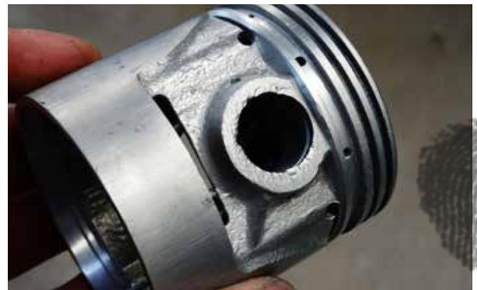
Eine Form des schonenden Reinigens von Motoren und Motorteilen ist das Strahlen mit Salz bei etwa 5 bis 6 Bar. Diese Form des Strahlens wird schon seit langem in der Automobilindustrie bei Motoren von Rennfahrzeuge eingesetzt. Besonders für das Strahlen des gesamten Motorenblocks ist Salz die optimale Lösung.
