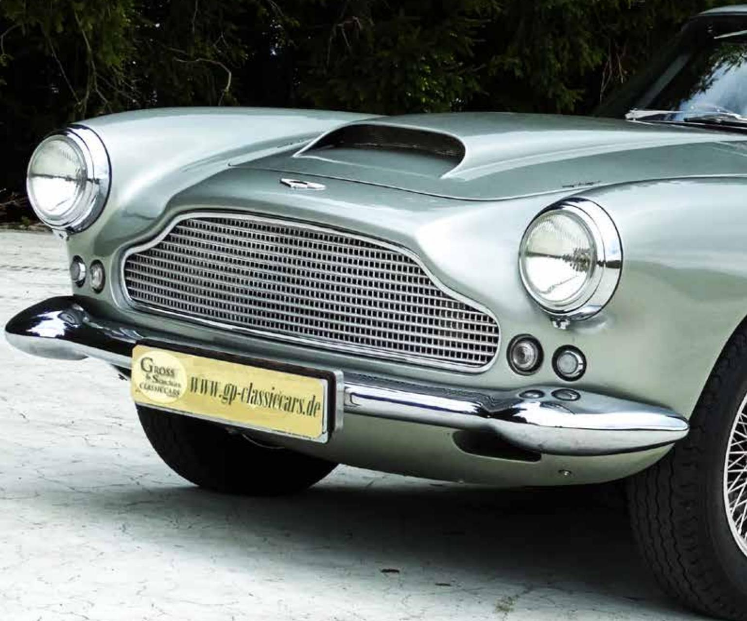
Aufgebaut wurde die Aluminium Karosserie auf einen Plattformrahmen mit einem Gitterrohr-Skelett. Technik, Motor und Fahrwerk wurden in Großbritannien im Aston Martin Werk bei Newport Pagnell gefertigt.
