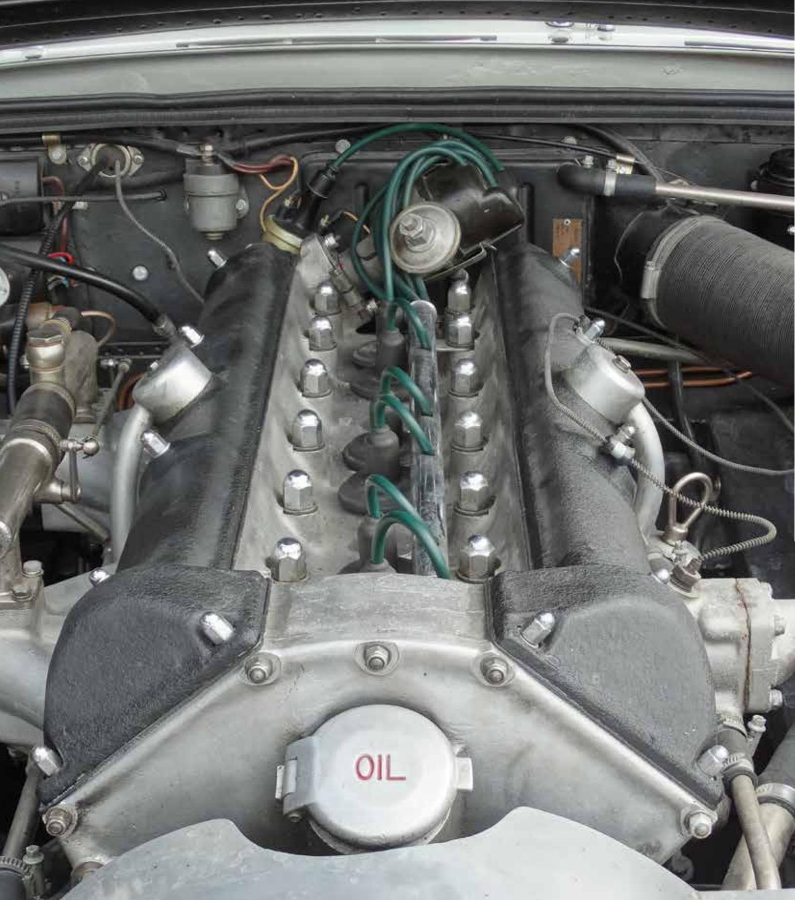
Angetrieben wird der DB 4 durch ein 3,7 Liter 6-Zylinder Triebwerk mit einer Leistung von 306 PS / 6000 U/min. Damit erreicht der kraftvolle Sprinter eine Höchstgeschwindigkeit von 235 km/h. Von 0 auf 100 km/h beschleunigt er in 6 Sekunden.
