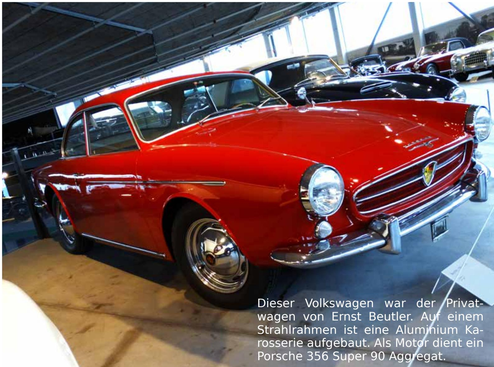
Dieser Volkswagen war der Privatwagen von Ernst Beutler. Auf einem Strahlrahmen ist eine Aluminium Karosserie aufgebaut. Als Motor dient ein Porsche 356 Super 90 Aggregat.
