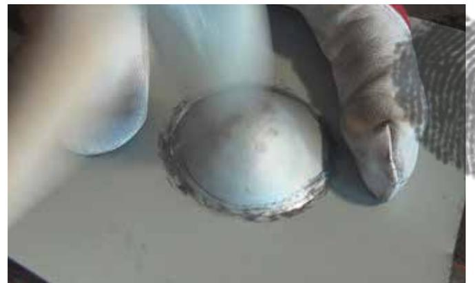
Um die Endspitze des Lampentopfs für das Rücklicht zu formen, benötigt man ein stabiles Stahlrohr-Ende. Das Blech wird auf das Rohr gelegt. Mit einem Kunststoff- oder Holz-Rundhammer wird das Blech nun in die Öffnung des Rohrs getrieben.
