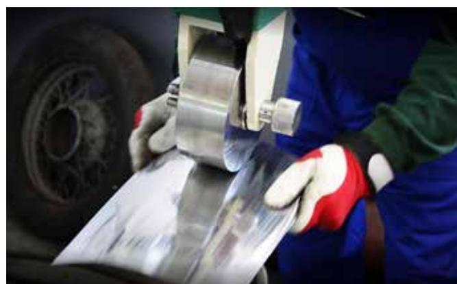
Die Rollenstreckmaschine ist ein sehr hilfreiches Werkzeug in der Karosserie Werkstatt. Je nachdem, wie man die Rollenstreckmaschine einsetzt, erhält man auch unterschiedlichste Ergebnisse. Es gibt einige Grund-Techniken, die zum gewünschten Ergebnis führen.
