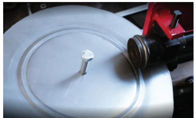
Kreisförmige Sicken, wie sie in Abdeckungen, Radkappen oder Zierteilen zu finden sind, lassen sich sehr einfach mit der Sickenrollmaschine und einer kleinen zusätzlichen Vorrichtung formen.
