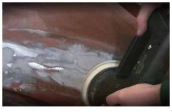
Nach dem Schweissen oder Verzinnen von Karosserie-Teilen entstehen häufig noch kleine Unebenheiten im Bereich der Ausbesserungsarbeiten. Um diese Bereiche für die spätere Lackierung vorzubereiten, kann mit Hilfe von Stahl-Polyster Spachtelmasse, wie die hier gezeigte Masse von Voss Chemie die betroffene Stelle ausgebessert werden.
