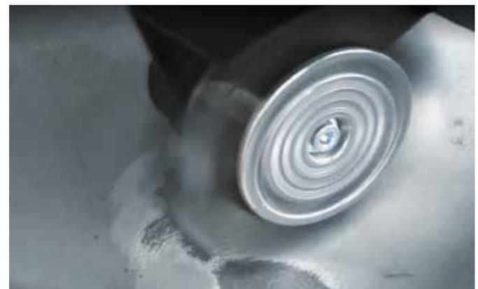
Das Entfernen von Lacksprüngen mit Rostansätzen, Rostblasen oder Flugrost sind bei jeder Lack- oder Karosserie-Restaurations eines der ersten Schritte.
