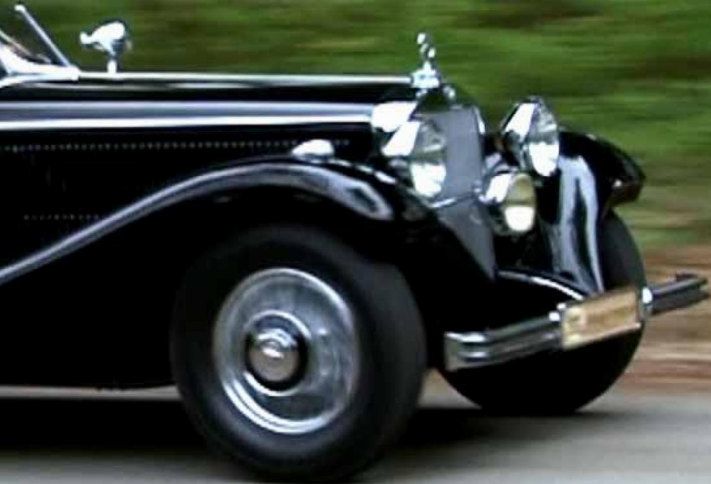
Die besonders gute Straßenlage des Mercedes 290S gelingt durch die neuartige vordere Radaufhängung. Die beiden vorderen Räder wurden einzeln an zwei Schwinghebeln (heute würde man sie als Querlenker bezeichnen) aufgehängt. Die obere Querblattfeder wurde durch zwei Schraubenfedern ersetzt. Lediglich die untere Querblattfeder aus den Vorgängermodellen wurde belassen.
