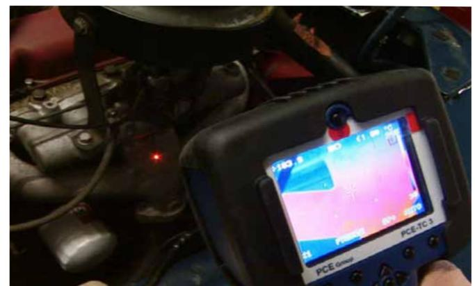
Ob beim Oldtimer-Kauf oder aber auch bei der Funktionsprüfung des Motors ist die Temperaturanalyse ein Weg, Aufschlüsse über den Zustand des Motors zu geben.
