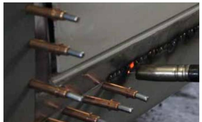
Beim Karosseriebau ist es oft notwendig, die einzelnen Bleche testweise zu fixieren, um die Passgenauigkeit vor dem Schweißen überprüfen zu können. Zudem sind die Bleche dann so fixiert, dass immer beide Hände für eventuell Korrekturen frei sind.
