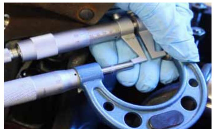
Nachdem die Kurbelwelle und alle Lager gereinigt sind, geht es daran, die einzelnen Lagerbrücken zu prüfen und zu messen. Mit einem Innenmikrometer wird der Abstand zwischen den beiden Reibflächen eines Lagers an der Kurbelwelle gemessen.
