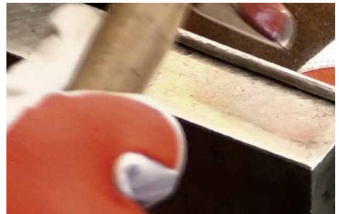
Bauteile wie Kotflügel weisen am Rand oft eine Drahtkante als Kantenschutz auf. Für eine solche Drahteinlage muss bereits beim Zuschnitt genügend Material zugegeben werden. Je nach Neigung des Blechs liegt diese Drahtzugabe bei dem 2fachen bis 3 fachen Durchmesser des Drahtes der eingelegt wird. Der Draht wird daher zuerst gemessen und der entsprechende Rand auf das Blech übertragen.
