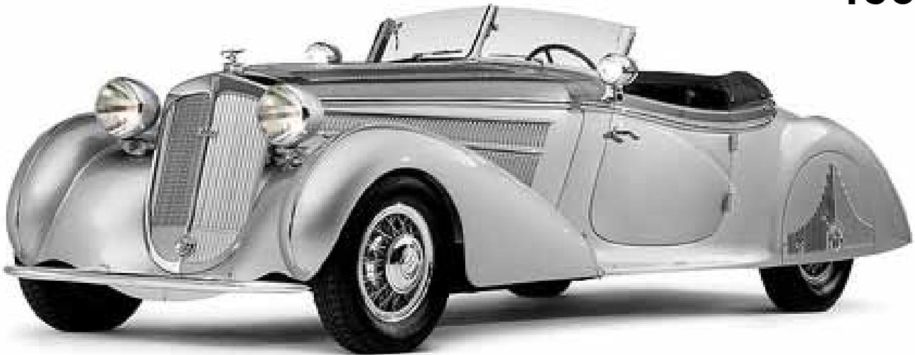
Diesen Horch mit einem 4944 ccm Motor kleidet eine Sonderkarosserie von Erdmann & Rossi. Es ist einer der drei überlebenden Exemplare von fünf gebauten Fahrzeugen.
