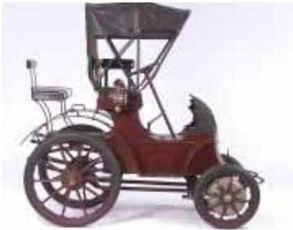
Ludwig Lohner baut in der ungarisch-österreichischen Monarchie das erste Automobil. Anfangs noch mit einem Zweizylindermotor und Glührohrzündung, später aber nur mit elektrischem Antrieb.
