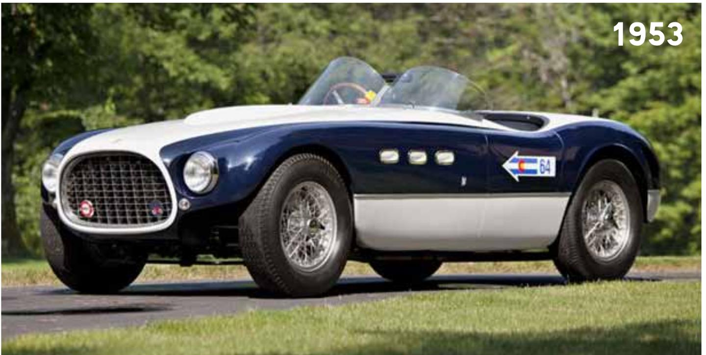
Nur zehn Exemplare des Ferrari 340 wurden je gebaut. Dieser Ferrari mit einer windschnittigen Vignale Karosserie ist absolut original erhalten und zeugt von seiner Renn-Historie. Ein von Aurelio Lambredi entwickelter 4,5 Liter V-12 Motor erzeugt eine Leistung von 375 PS. Auffällig sind die beiden rund geformten Windschutzscheiben.
