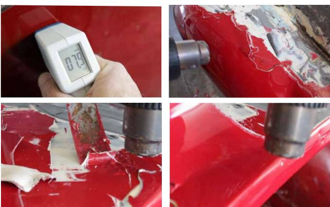
Vor der Lackierung ist nach der Lackierung. Dieses Motto garantiert ein gutes Resultat. Daher ist bei Fahrzeugen, die mehrfach gespachtelt und lackiert wurden das Entlacken unerlässlich. Der Abtrag des Lacks geht am einfachsten mit einem Heißluftföhn und einem Spachtel.
