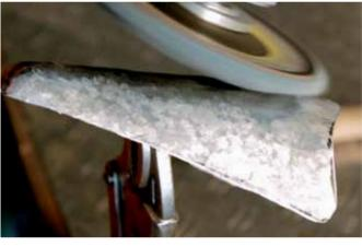
An älteren Fahrzeugen findet man häufig auf den Kotflügeln aufgesetzte Blinker-Gehäuse. Solche Blinker-Gehäuse können aus einem Stück mittels der Technik des Rundens nach gefertigt werden.
