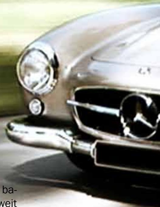
Dieses elegante Sport-Coupé mit den legendären Flügeltüren basiert auf einem extrem verwindungssteifen Gitterrahmen, der weit bis über die Flanken reicht. Dies ist der Grund, weshalb keine herkömmlichen Türen eingesetzt werden konnten und die auffälligen Flügeltüren erstmals zum Einsatz kamen. Im englischen Sprachbereich wird das 300 SL Coupé daher auch „Gullwing“ – Möwenflügel - genannt.
