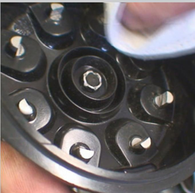
Verteilerkappe mit weichem Tuch reinigen
