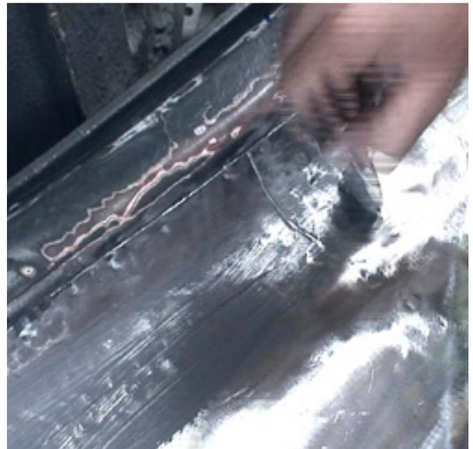
Bei der Oldtimer Restauration wird bei den Blecharbeiten nicht selten die überlappende Naht eingesetzt. Nachteil einer solchen Naht ist, dass später an solchen Stellen die Feuchtigkeit eindringen kann und sich an diesen Stellen Rost bildet.
