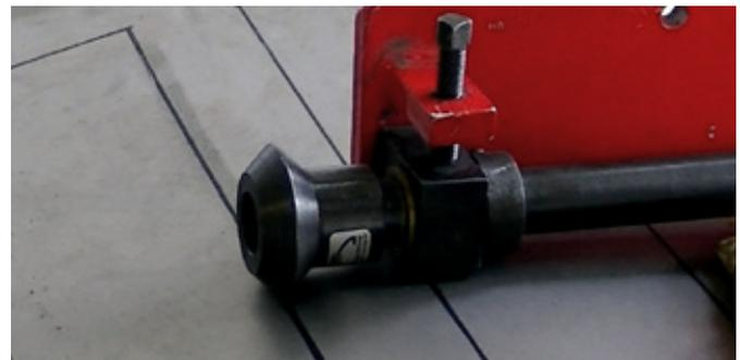
Für die Anfertigung von Sicken kommt unter anderem immer wieder die Sickenrollen-Maschine zum Einsatz. Paarweise angeordnete Profil-Rollen bestimmen die Form und Tiefe der Sicke. Sicken in Ersatzblechen können auch mit der Sickenrollenmaschine hergestellt werden. Die Verwendung der Sickenrollenmaschine erfordert etwas Verständniss
