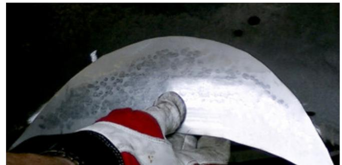
Bereits im ersten Teil wurde auf die Technik des Aufziehens eingegangen. Dabei wird das Blech auf einer flachen Unterfläche ringförmig mit einem Kugelhammer getrieben. Durch das Aufziehen entsteht eine Wölbung. Diese Technik findet zum Beispiele bei der Formung eines Motorradtanks ihren Einsatz. Übergänge mit stärkeren Wölbungen können so geformt und gerundet werden.
