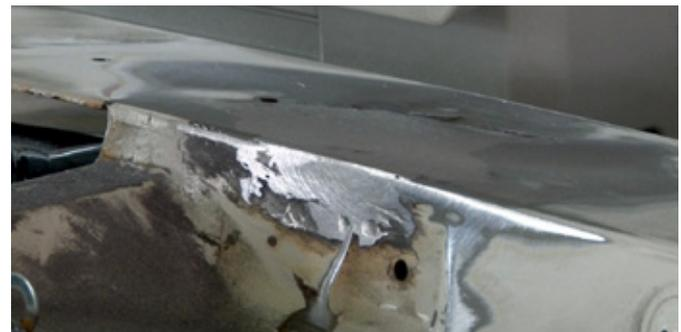
Die Heckklappe hat noch weitere Dellen von dem Unfall. Diese Dellen müssen ebenfalls herausgezogen werden. In diesem Falle werden entlang der Verformungslinie einzelne Rundscheiben aufgeschweißt. Da in der Mitte eine Sicke verläuft, wird auf der Höhe der Sicke die erste Scheibe aufgeschweißt. Mit einem Haken und dem Gleithammer kann nun die Beule entsprechend herausgezogen
