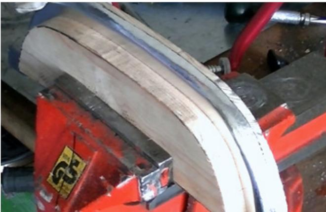
Das Blech wird zwischen die zwei Holzformen geklemmt. Die eine Holzschablone ist etwas kleiner als die eigentliche Klopfschablone, damit das Blech entsprechend abgerundet werden kann. Das Blech wird nun mit einem Hammer über die Klopfform getrieben. Dies geschieht möglichst langsam und Stück für Stück. Würde man das Blech zu schnell umtreiben, gäbe es Falten, die anschließend nicht mehr geglättet werden können.
