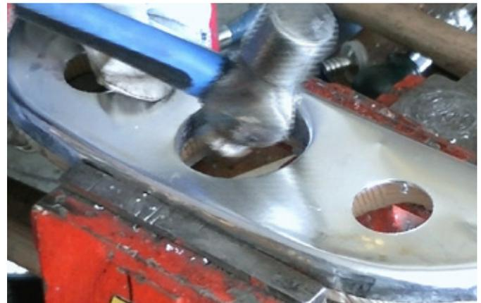
dienen als Zentrierpunkt für den Stufenbohrer, mit dem die Sickenlöcher entsprechend vorgebohrt werden.
