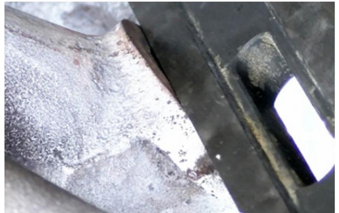
Falschluff muss nicht immer vom Vergaser kommen. Ein Hinweis auf Falschluff ist eine erhöhte Drehzahl und Fehlzündungen beim Beschleunigen. Eine Ursache kann auch die unebene Flansch-Stelle des Ansaugkrümmers am Zylinderkopf sein. Durch die erhöhte Temperaturbelastung kann sich der Ansaug- und Abgaskrümmer über die Jahre hinweg verziehen und liegt daher nicht mehr plan an.
