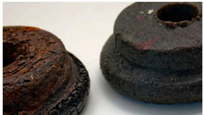
Alte Fahrwerks- oder Karosseriegummis müssen oft aufgrund ihres Alters ersetzt werden. Sei werden brüchig und damit auch zum Teil funktionsuntauglich. Neue Gummis können auch selber angefertigt werden
