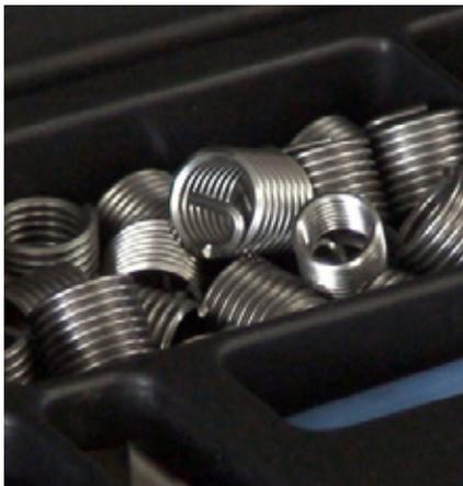
Wenn das Innen-Gewinde des Stehbolzens oder einer Flansch-Befestigung ausgerissen ist, ist dies nicht das Ende des Bauteils. Soge-
