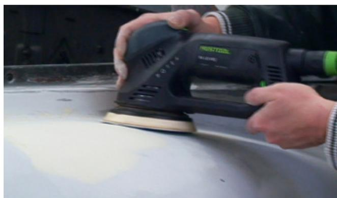
Wenn die Blecharbeiten am Oldtimer abgeschlossen sind und die Stoßkanten und Schweiß-Nähte verzinkt wurden, kann das Fahrzeug für die Lackierarbeiten vorbereitet werden.
