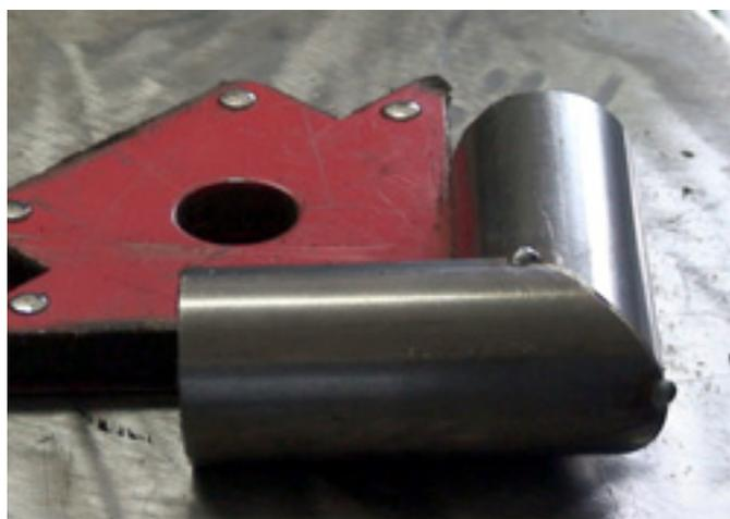
Bisher wurden nur die Techniken für das Verschweißen von flachen Blechen behandelt. Für das Schweißen von Rahmenteilen kommt allerdings auch die Technik der Rundkehlnaht zum Einsatz. Verschweißt man zum Beispiel ein Rohr mit einem flachen Blech, ist ähnlich wie bei der regulären Kehlnaht (<http://www.oldtimer-tv.com/oldtimer/DE/tipps-tricks/index.php?Seite=174>), der Brenner in einem Führungswinkel von ca. 45° bis 55° zu
