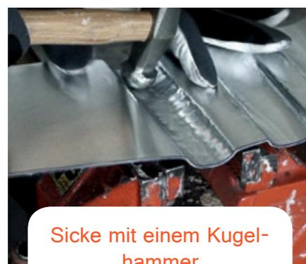
Sicke mit einem Kugelhammer
